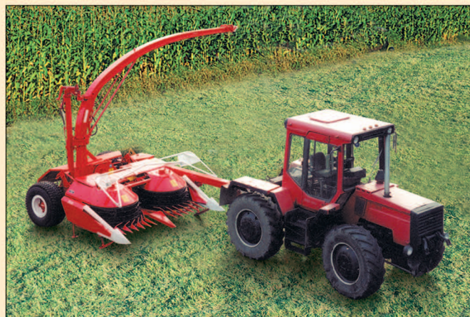
Комбайн «ПАЛЕССЕ FT40» в агрегате с трактором Harvester «PALESSE FT40» aggregated with a tractor
