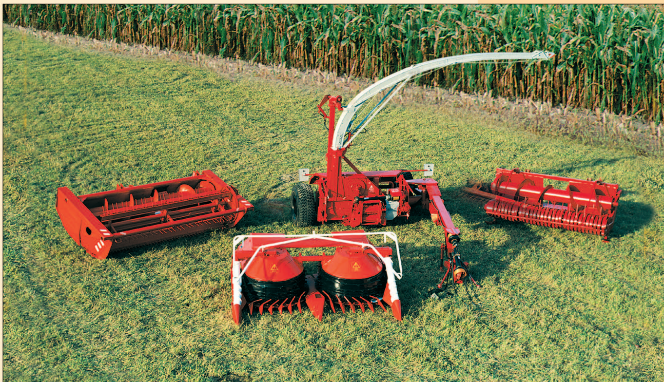
Прицепной кормоуборочный комбайн «ПАЛЕССЕ FT40» с комплектом сменных рабочих органов Pull-type forage harvester «PALESSE FT40» with a set of implements
