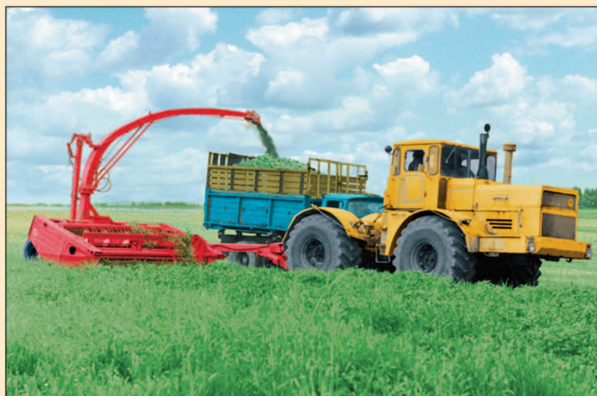
Комбайн «ПАЛЕССЕ FT40» на кошении трав с измельчением Harvester «PALESSE FT40» for cutting and chopping
